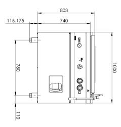
E - přívod napětí 400V WD - přívod vody do duplikátrou W - přívod vody
